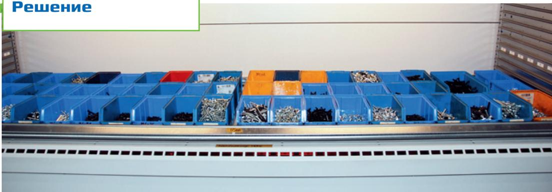
Были установлены две системы Shuttle XP 500, имеющие в общей сложности 110 несущих полок (средних X типа 2, грузоподъемностью 460 кг). Кроме того, программное обеспечение для управления складом Power Pick Global было полностью интегрировано в домашнюю EPR-систему.
